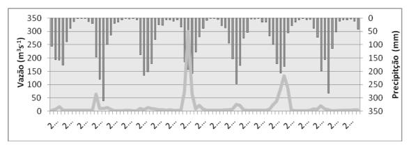
FIGURA 06 - Séries de Precipitação e vazão plotadas para o período em foco, 2001 a 2007.
