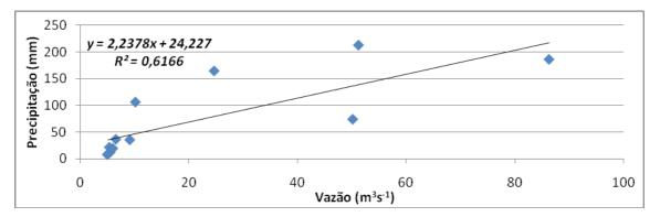
FIGURA 04 - Dispersão dos dados de precipitação / vazão normalizadas climatologicamente (1969-2000), com a referida reta de regressão linear e o coeficiente de determinação (R²) para a bacia Hidrográfica em estudo no período analisado.
