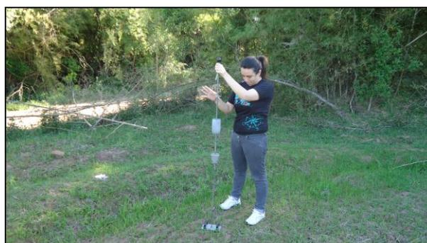
Figura 57: Teste de resistência à penetração no ponto cinco de coleta
