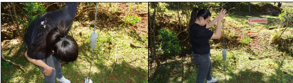
Figura 52: Teste de resistência à penetração no ponto três de coleta e;
