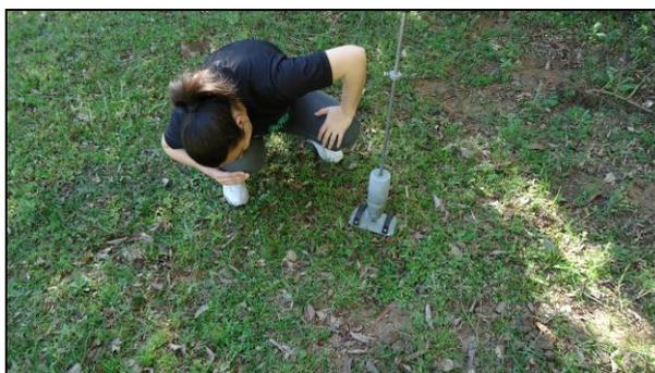
Figura 55: Teste de resistência à penetração no ponto quatro de coleta
