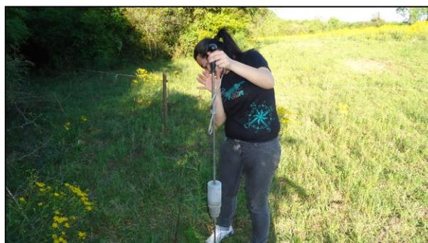
Figura 59: Teste de resistência a penetração no ponto seis de coleta
