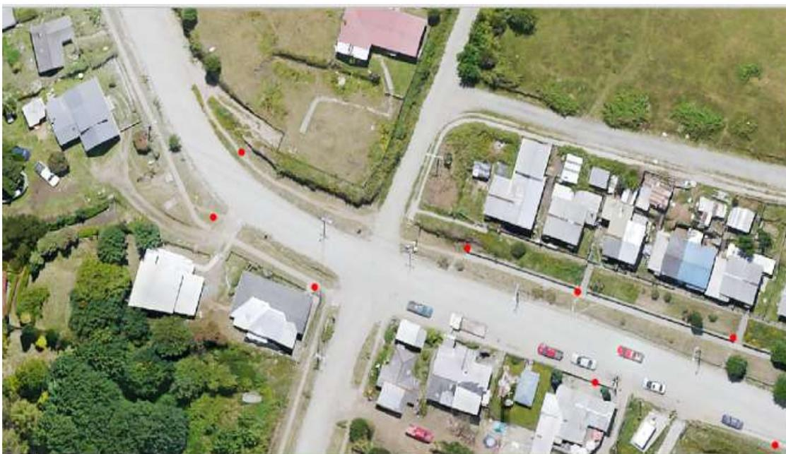
Figura 7. Puntos de chequeo sobre la ortofoto.
