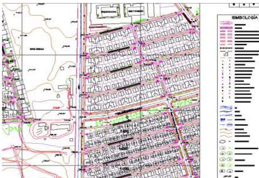
Figura 8. Levantamiento fotogramétrico convencional urbano a escala 1/1000.
