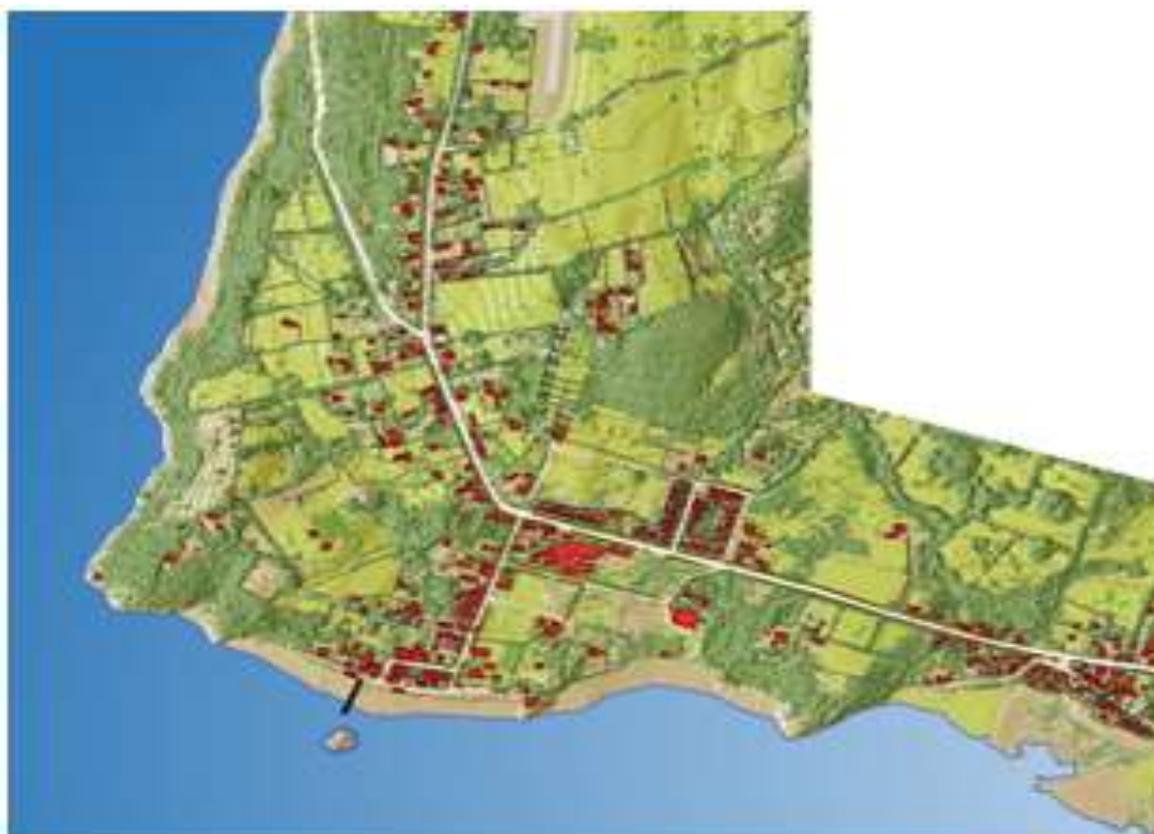
Figura 12. Restitución fotogramétrica incorporando capas en formato raster.
