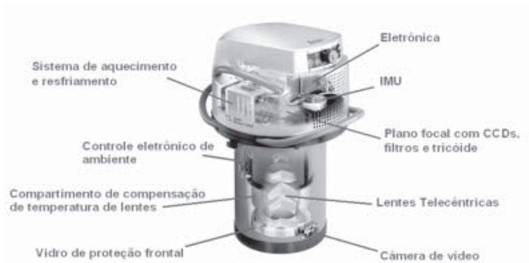
**Figura 3.** Montagem da câmara aérea digital ADS40 em uma aeronave
