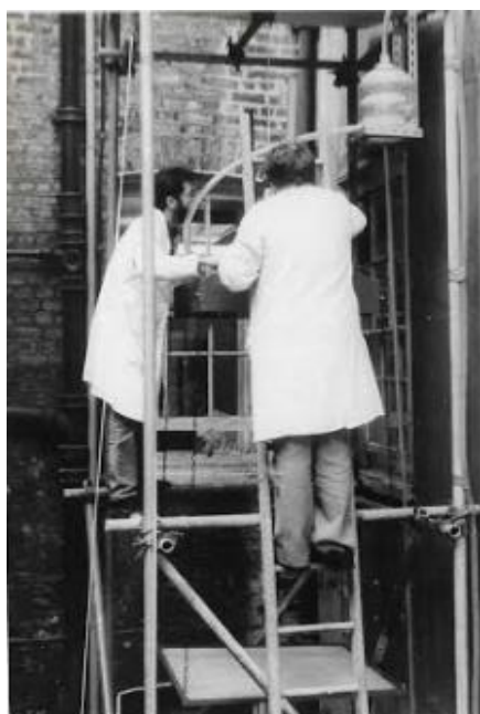
Simulador de chuvas, construído no King's College London, para monitorar erosão. Foto Antonio Guerra (1989).
