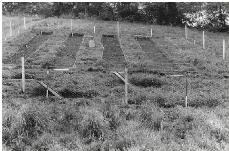
Estação experimental, montada em Rogate, na Inglaterra, para monitorar perda de água e sedimentos. Foto Antonio Guerra (1989).
