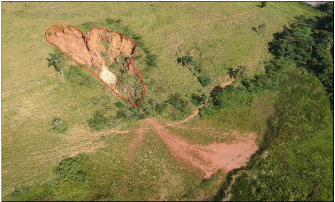
Voçoroca, em área de pasto, no município de Rio Claro (RJ). Pode-se notar semelhança de forma, entre a cicatriz da voçoroca e o material depositado à jusante. Foto: Fabrizio Garritano (capturada com VANT), 2020.
