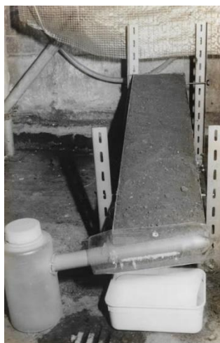
Flume, onde o solo é colocado para ser exposto à simulação de chuva. Foto Antonio Guerra (1989).
