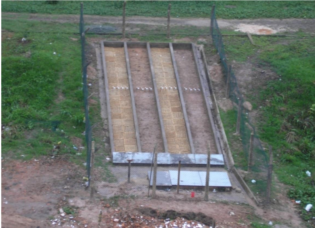
Estação experimental, em terreno da UFMA, São Luís, para monitorar escoamento superficial e perda de solo. Foto Fernando Bezerra (2010).
