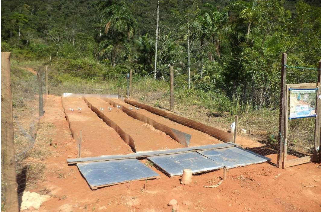
Estação experimental para monitorar perda de água e solo, contendo três parcelas. Bacia do rio Maranduba, Ubatuba – SP. Foto: Leonardo dos Santos Pereira(2016).
