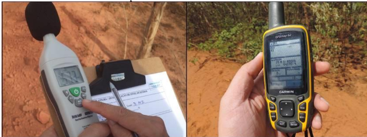
Figura 1 – À direita decibelímetro digital, e à esquerda GPS, ambos utilizados durante as campanhas de coleta do nível de ruído
