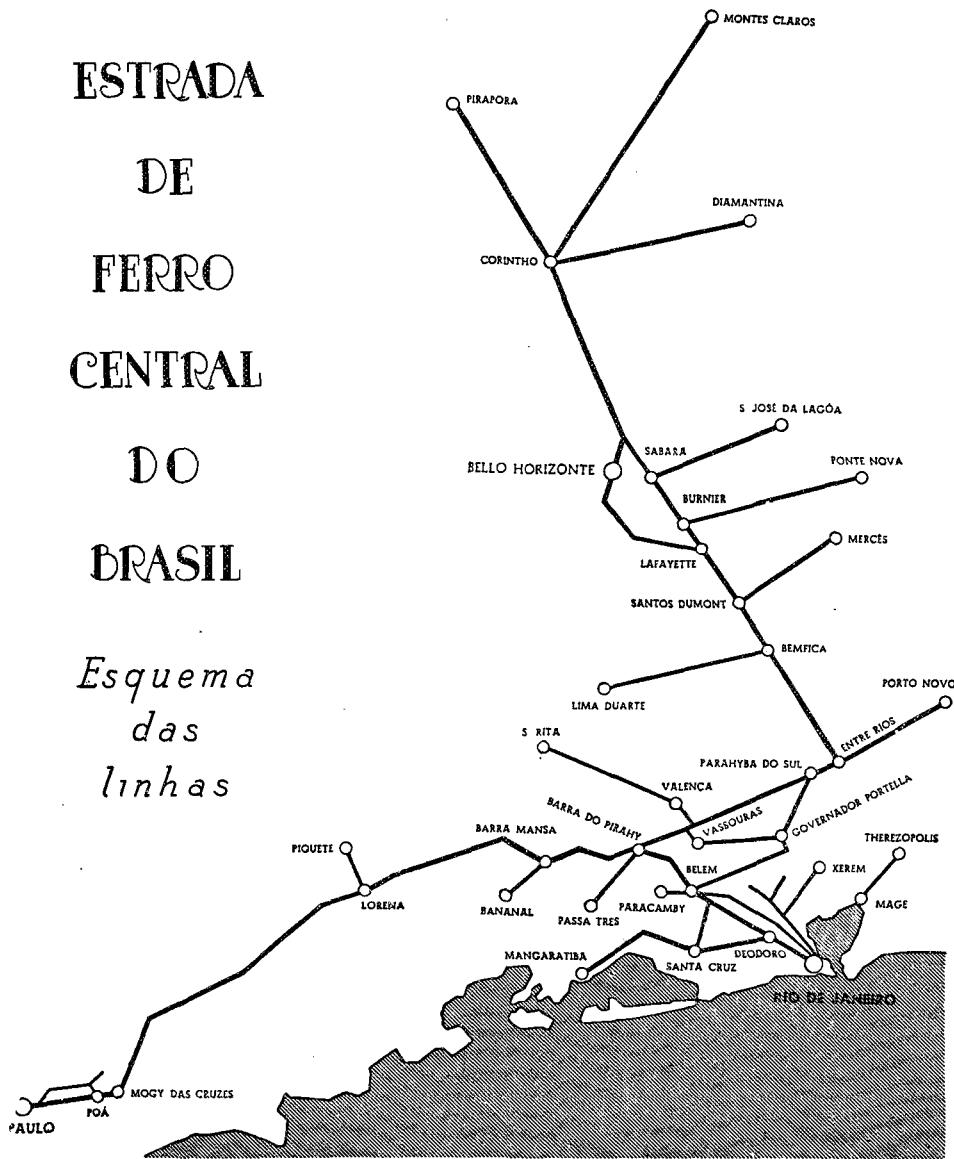
Rede *arborescente* (ou *dendroforme*), ou rede *captante* (ou de *expansão*), quando a linha principal se sub-divide e os ramais e sub-ramais se multiplicam, assumindo a rede ferroviária, em planta, esquematicamente a figura de uma árvore, com o tronco, os galhos e os ramos.
