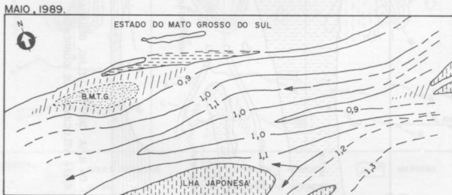
FIG. 04 - CURVAS DE ISOVELOCIDADE DE FLUXO NO RIO PARANÁ. A MORFOLOGIA DAS MARGENS E O POSICIONAMENTO DAS ILHAS DETERMINAM "ZONAS DE SOMBRA" (VELOC. < 0,9 m/s), PODENDO GERAR BARRAS ARENOSAS.
