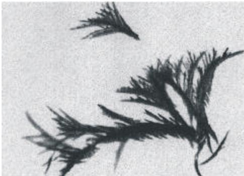
**Figura 8** - Microfotografía (250x) de cristales dendríticos azules de  $\text{CoHg}(\text{SCN})_4$ .
