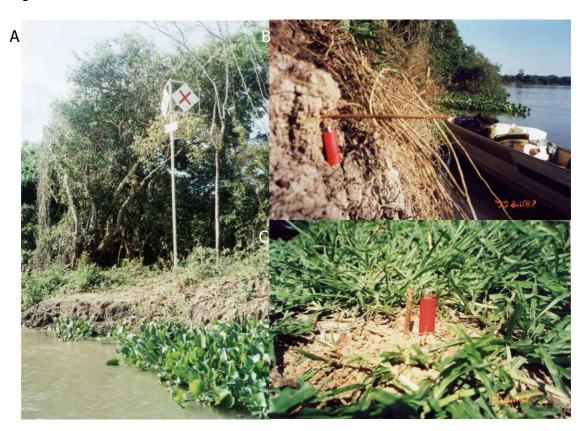
Figura 2 – Visualização dos procedimentos realizados para monitorar a erosão nas margens (A), mastro da Marinha (B), estaca e (C) pino de erosão.
