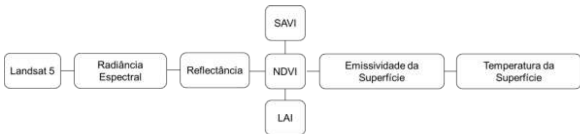
Figura 2. Fluxograma para obtenção da temperatura de superfície.
