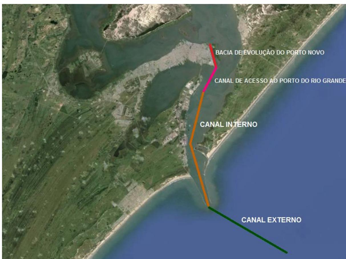
**Figura 8:** Imagem de localização das áreas frequentemente dragadas. **Fonte:** Google Earth (adaptado pela autora).
