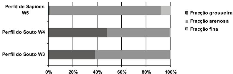
Figura 4 - Análise granulométrica dos perfis analisados
