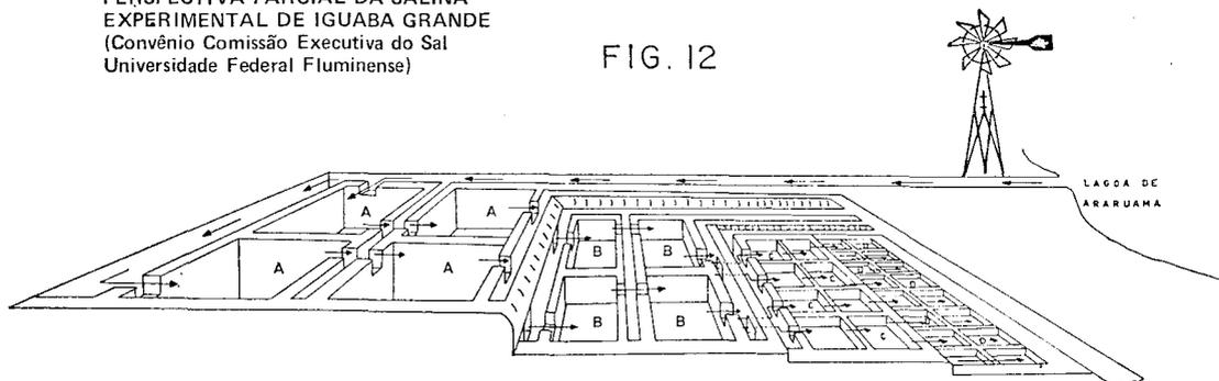
A - TANQUES DE CARGA B - PRÉ-CONCENTRADORES C - CONCENTRADORES D - CRISTALIZADORES → DIREÇÃO DA ÁGUA
