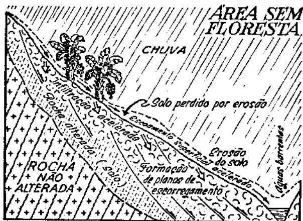
FIGURA 4 : Alteração no ciclo hidrológico causada pela retirada da mata, segundo BIGARELLA, 1974.
