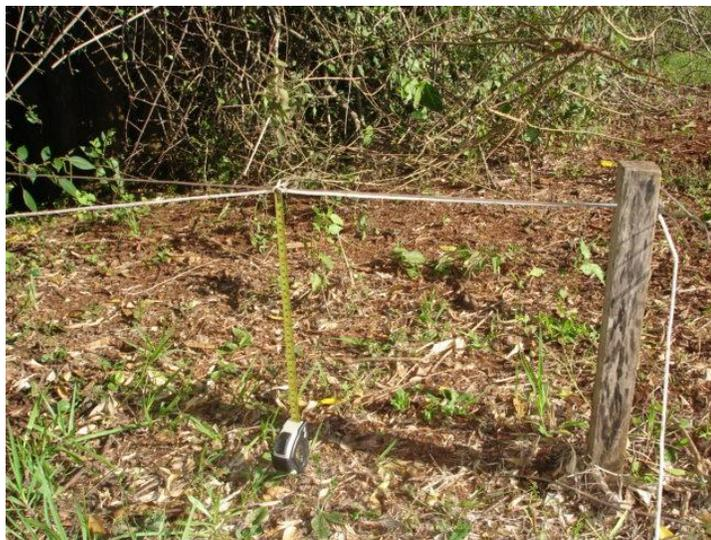
**FIGURA 4 - Estaca de madeira referenciada, nivelada e cimentada na margem direita do Córrego Peróba, Per1 (Foto: Oscar Vicente Quinonez Fernandez, fevereiro, 2008).**
