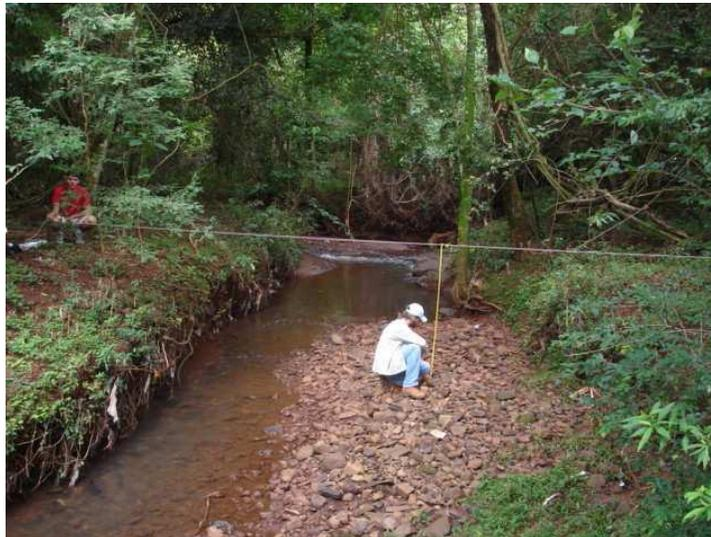
**FIGURA 3 - Medição de seção transversal na seção Mat1 (Matilde Cuê) em Marechal Cândido Rondon – PR (Foto: Oscar Vicente Quinonez Fernandez, janeiro, 2008).
