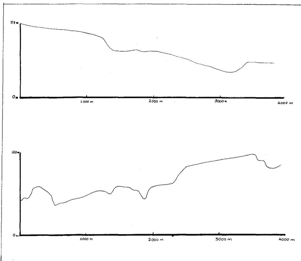
Fig. 1 — Perfis apresentados pelo baixo-platô terciário ao longo do traçado da rodovia Manaus-Itacoatiara (levantamento efetuado pelo DERA-Manaus).
