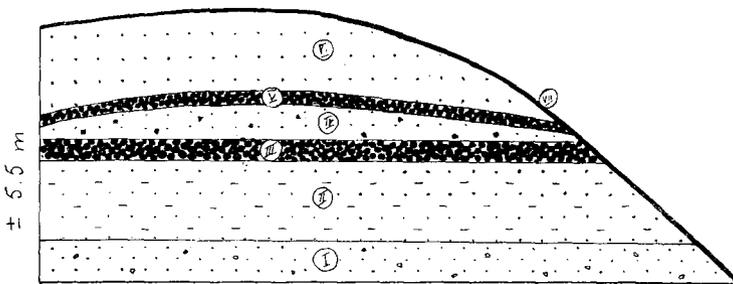
Fig. 13 — Corte esquemático na estrada Manaus-Itacoatiara a 216,1 km de Manaus. Corresponde a nível intermediário do modelado, cerca de 35 m acima das águas do Amazonas em cheia.
