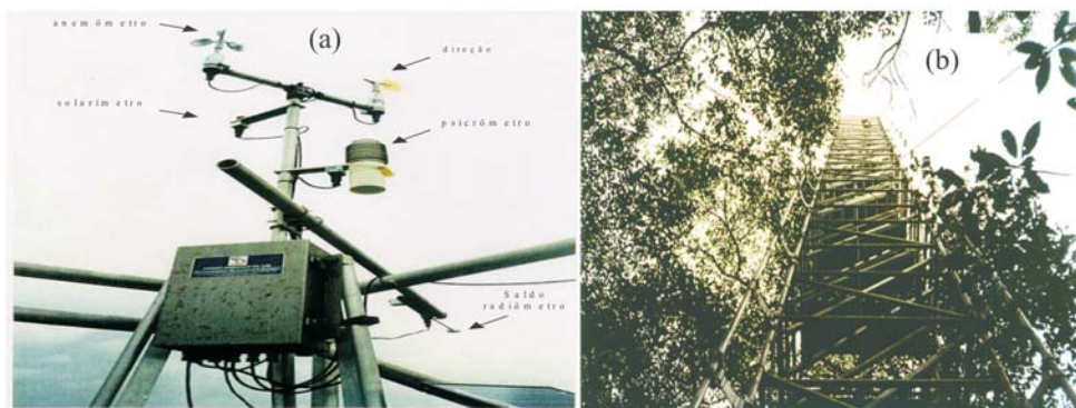
Figura 4 - Esquema da estação meteorológica automática (a) instalada no topo da torre micrometeorológica (b) no manguezal
