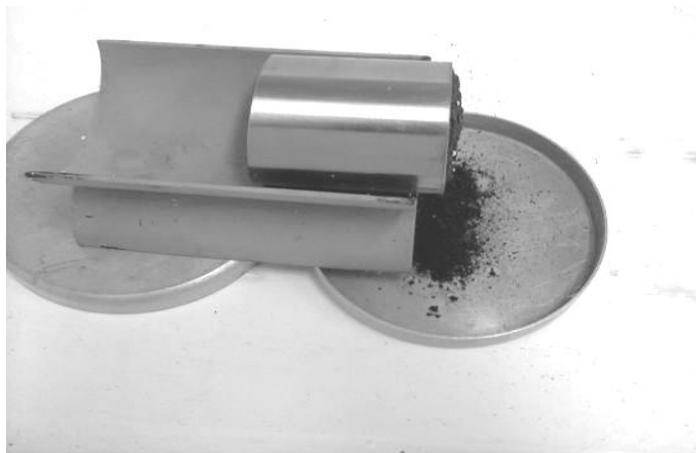
Figura 14 – Esquema do ensaio de Perda por Imersão
