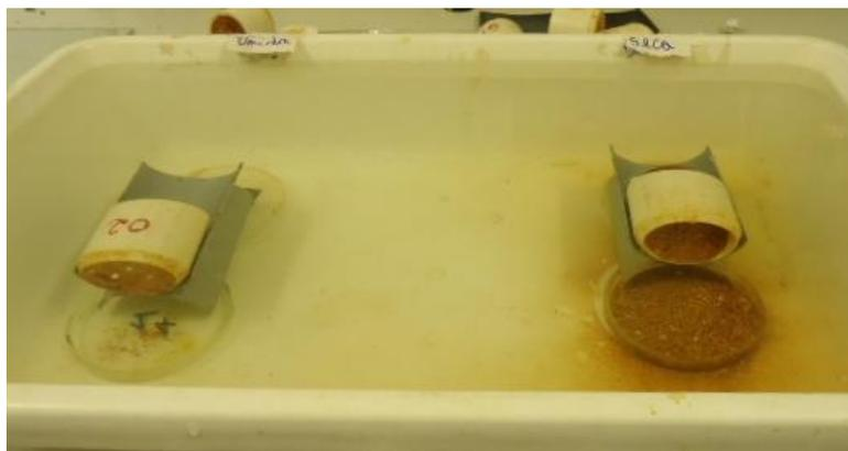
Figura 15 – Ensaio de Perda por Imersão na condição Pré-Umedecida e seca ao ar.
