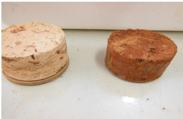
Figura 12 – Amostras preparadas para o ensaio desagregação nas condições de umidade seca ao ar (à esquerda) e umidade natural (à direita).
