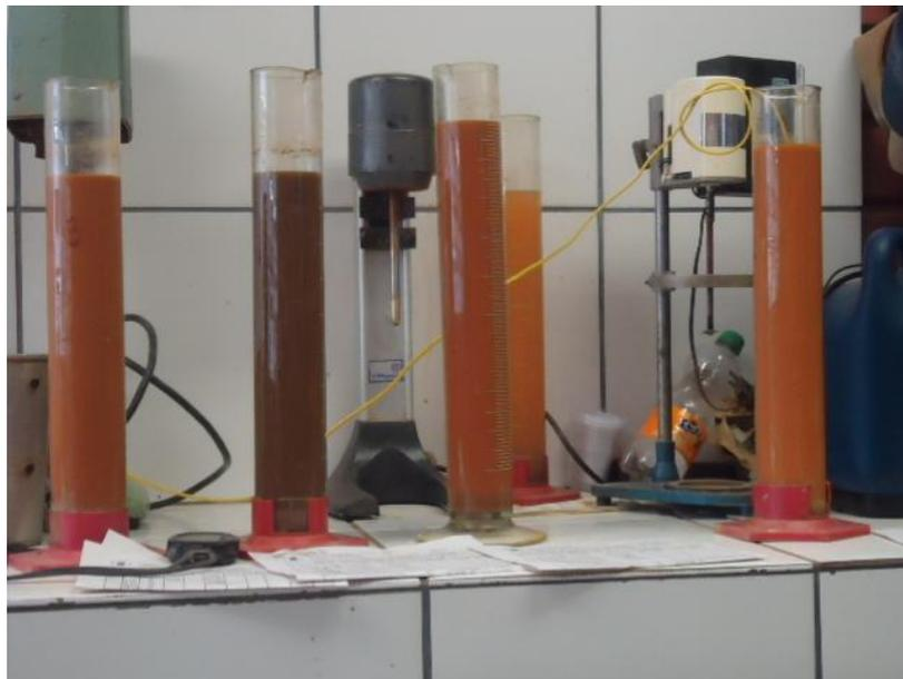
Figura 10 – Execução do ensaio da análise granulométrica Horizontes A, B, BC e C.
