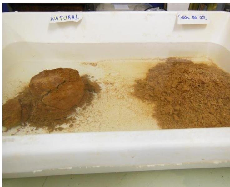
Figura 31 – Fase final do ensaio (após 24 horas). A amostra na condição natural apresenta ruptura nas bordas e fissuras no topo e a amostra seca ao ar, desagrega completamente.
