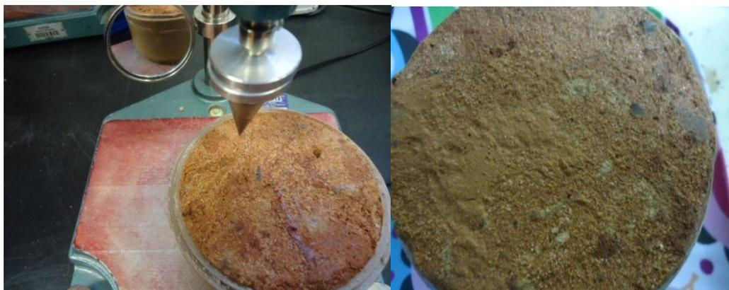
Figura 34 – Fotografias de detalhe do material ensaiado. Arenito com grânulos e lentes de material mais argiloso.
