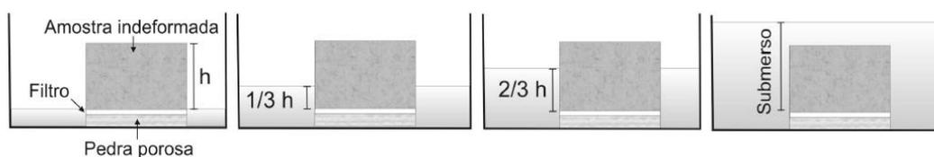
Figura 13 – Esquema representativo, do ensaio de desagregação.
