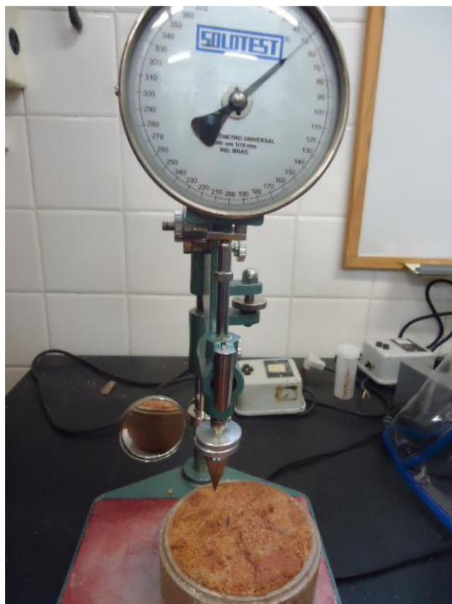
Figura 19 – Equipamento de cone de laboratório com amostra preparada para ser ensaiada.
